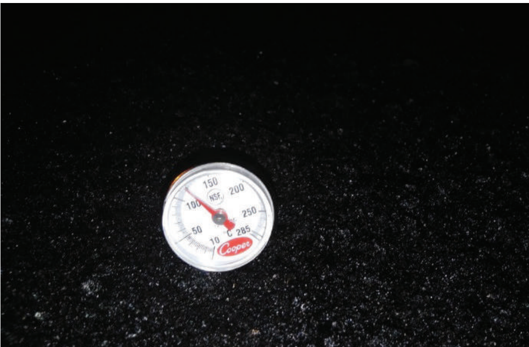
Suhu pematatan warm mix asphalt 115 \pm 5 °C.
