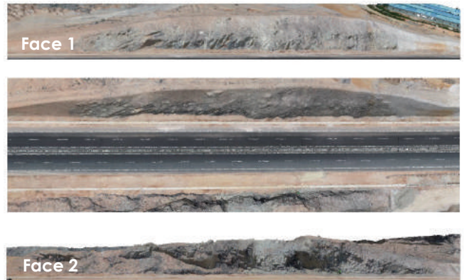
Rajah 7 Gabungan point cloud daripada TLS dan DCRP.
