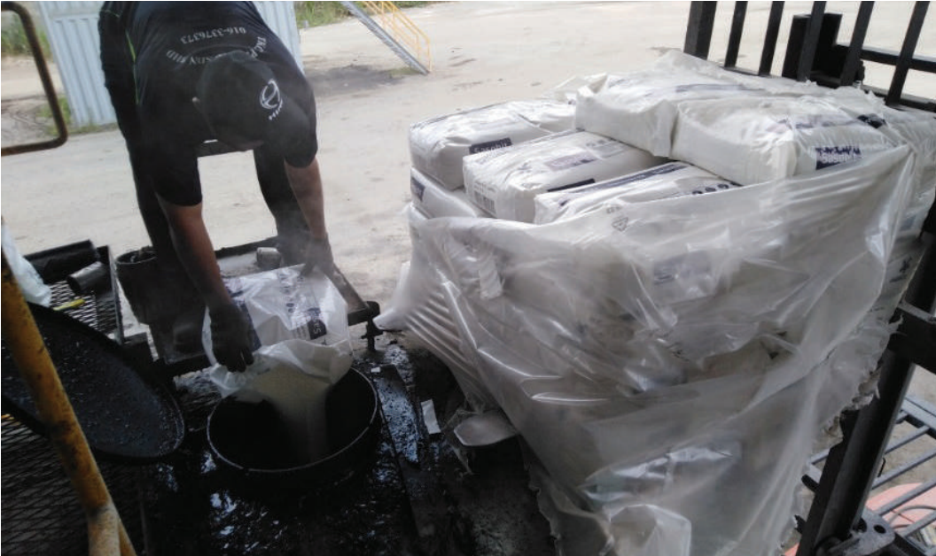
Bahan tambah dimasukkan ke dalam tangki bitumen untuk banchuan bahan pengikat di kuari TKC Premix, Pagoh.
